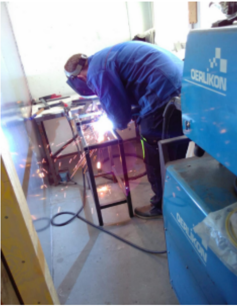
Beim Schweißen des Schreddergrundgestells
