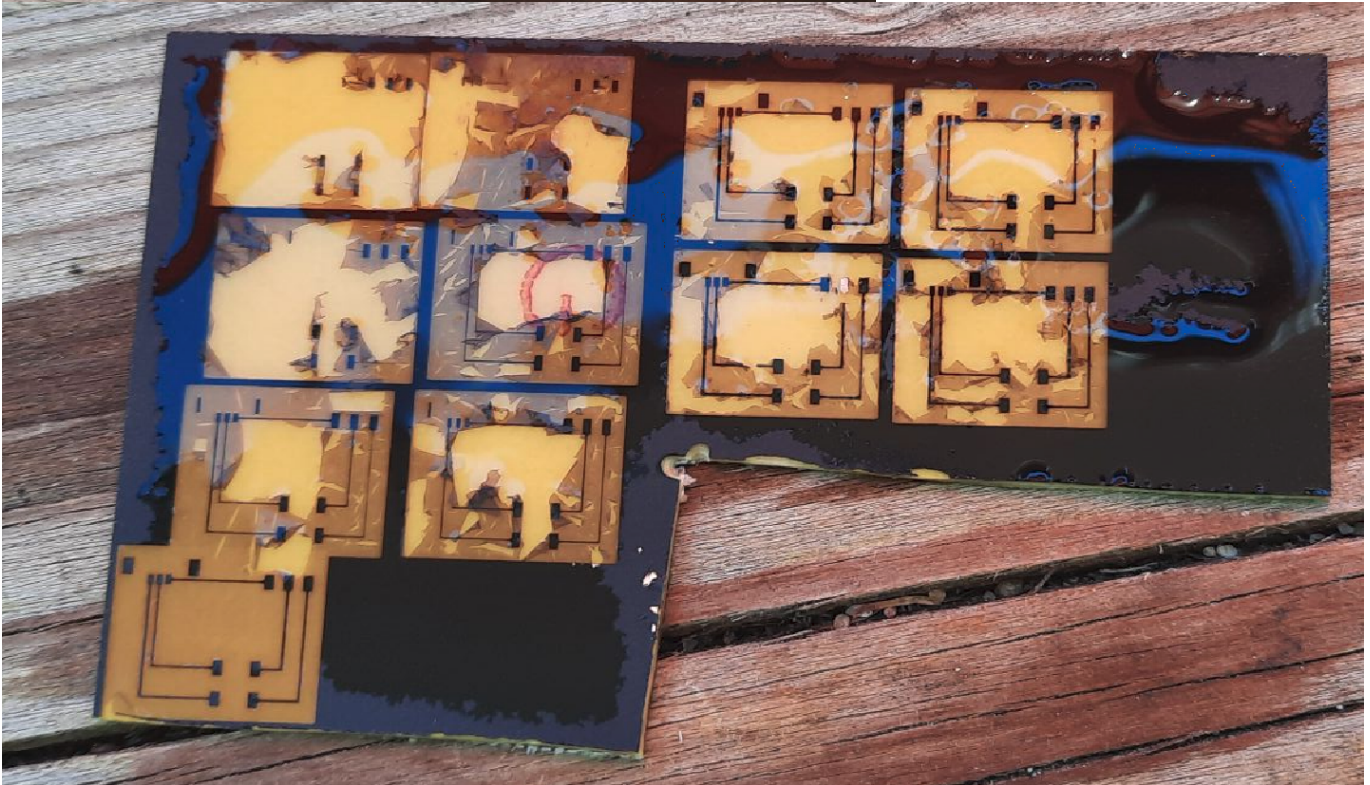
Die im Beispiel dargestellte Platine hatte leider zu dünne Stege
